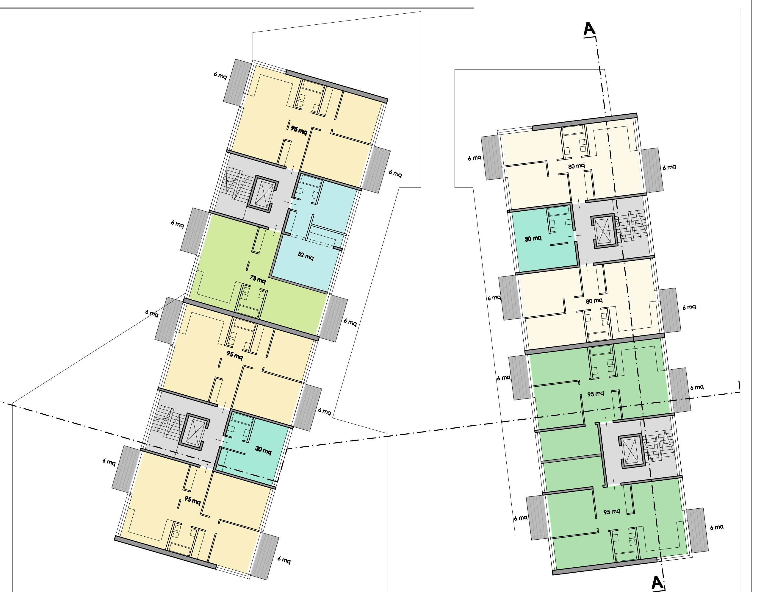
Piano Tipo: S.A. residenze: 3 x 95 + 73 + 30 + 52 = 440 mq 2 x 80 + 2 x 95 + 30 = 380 mq S.Acc. residenze: 16 x 6 = 96 mq PIANTA TIPO LIVELLI SUPERIORI (P2 - P6): Residenziale (* distribuzione tipi appartamenti esemplare)
